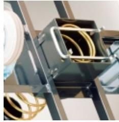
Ressort de la cuve mobile facilement interchangeable
