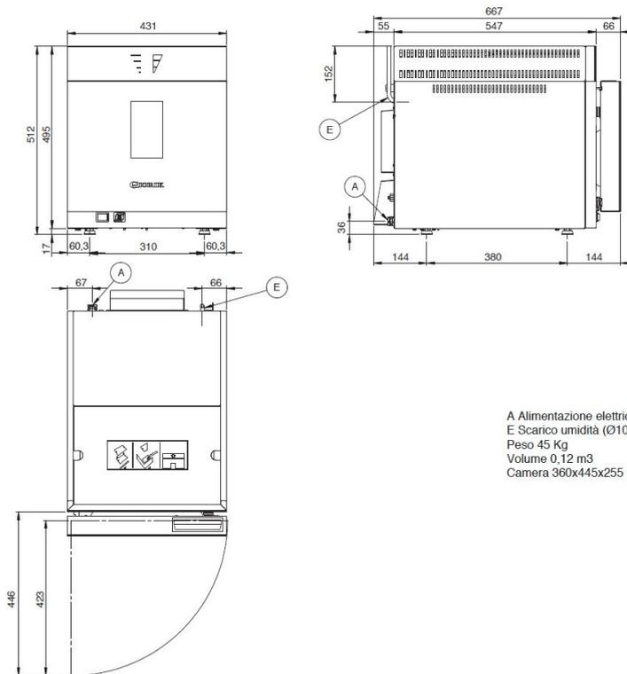
A Alimentazione elettrica (230V-1N 50Hz / 3,3kW)
