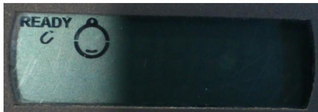
Pour démarrer l'enregistreur, il suffit de passer un aimant sur l'affichage de l'appareil. Il affichera **START** et une **alarme sonore** retentira :
