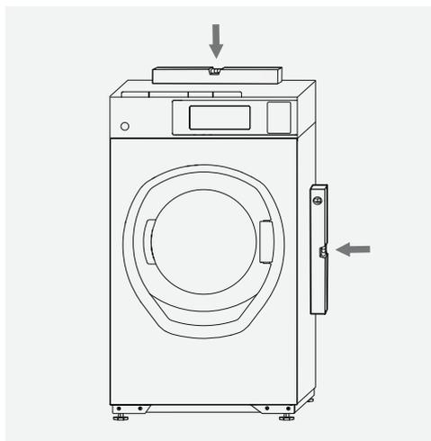
Alignez l'appareil de tous les côtés à l'aide d'un niveau à bulle d'air.
