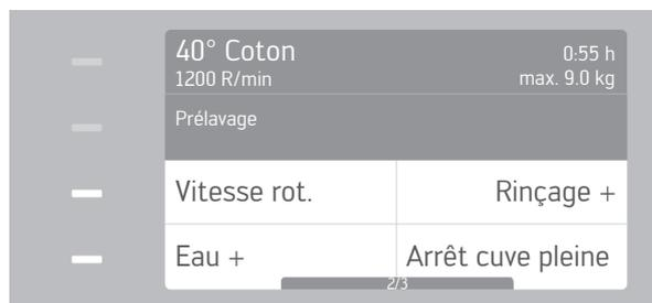
En tapant sur la barre lumineuse près de **Vitesse de rotation**, la vitesse de rotation peut être réduite par étapes de 100 R/min. À 0 R/min, il n'y a aucun essorage et le linge peut être retiré humide.
