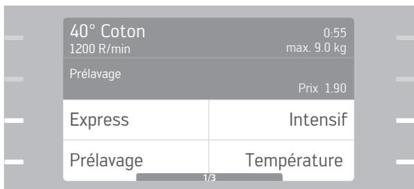
Le programme sélectionné avec sa durée, la vitesse d'essorage, la quantité de charge maximale et les options sélectionnées ainsi que le prix du programme s'affichent à l'écran.
