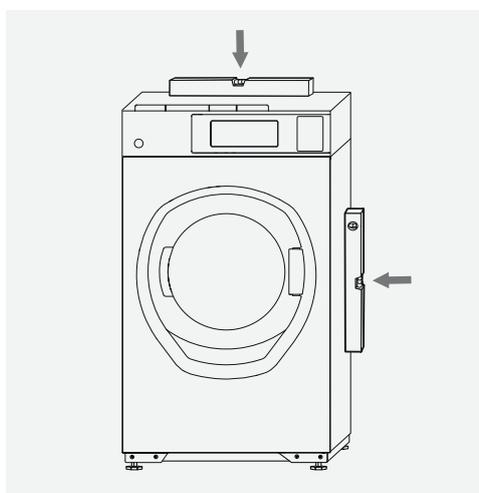
Alignez l'appareil de tous les côtés à l'aide d'un niveau à bulle d'air.
