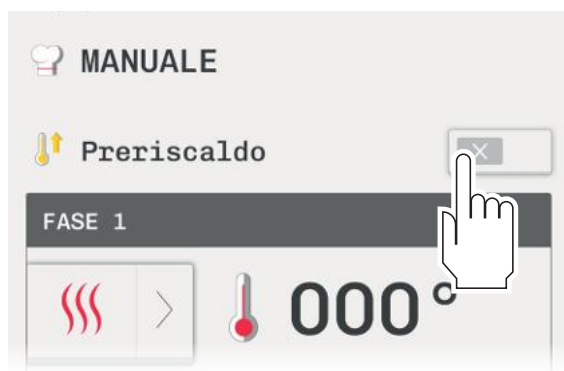
preriscaldamento disattivo préchauffage désactivé
