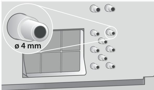
Les pompes de dosage pour le dosage automatique de la lessive liquide peuvent être raccordées à l'arrière de l'appareil.
