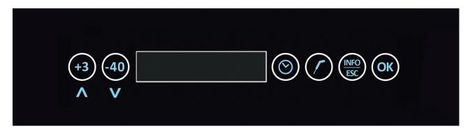
Les modèles sont dotés d'une carte électronique de puissance « Compact » et d'affichage mécanique « Glass ». L'interface utilisateur est dotée d'un afficheur LED à 6 chiffres avec visualisation par défilement et également de 6 boutons mécaniques comme suit :
